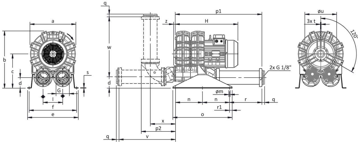
Konfiguration mit vertikalem Schalldämpfer ist nur mit dem Zubehör-Kit CK verfügbar; für alle Installationsoptionen kontaktieren Sie bitte FPZ.
