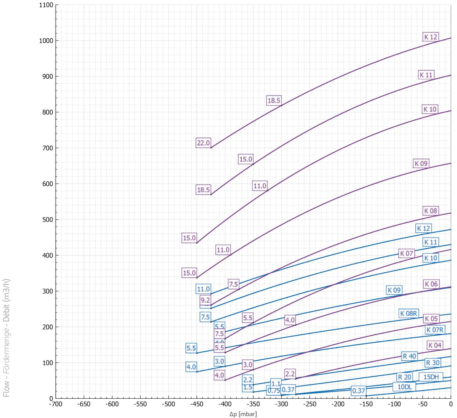
Static differential pressure - Statischer Differenzdruck - Pression différentielle statique hPa (mbar)
