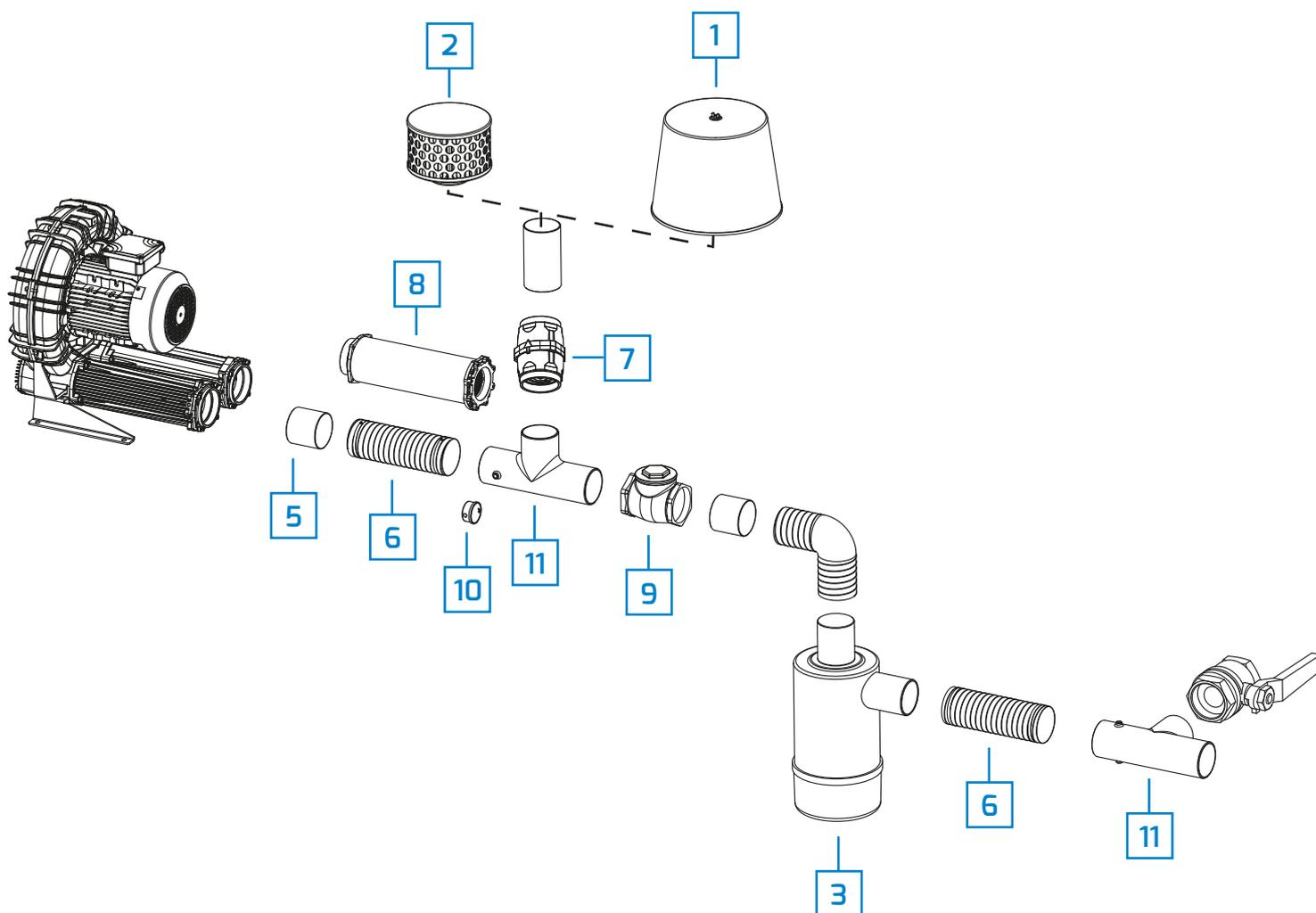
7 Vacuum/pressure relief valve - *Druckbegrenzungsventil Druck/Vakuum* - Soupape de limitation du vide/de la pression
